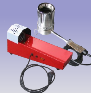
Kapszulaszugorítók asztali vagy kézi változatban
