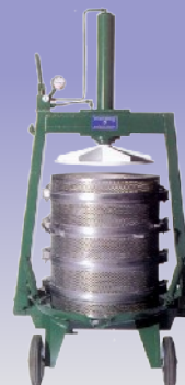
Hidraulikus, nyomólapos prések rozsdamentes vagy fakosaras kivitelben, 130 – 900 l kosártérfogattal.
