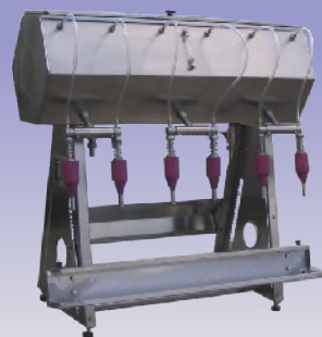
Rozsdamentes asztali töltőberendezés 2-4-6 fejes kivitelben. Telj.: 200 – 700 l/óra
